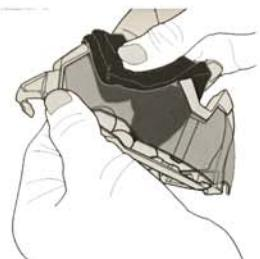
3. Jakmile jsou sklička správně umístěna v drážce, jemně přit-lačte na vrchní část ve středu rámu tak aby se jazýček na vrchu páčky uzamkl.
